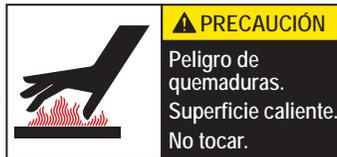
Widebody de forma muy agresiva a niveles de rendimiento máximos. Retire la escotilla y deje que estos componentes se enfríen durante aproximadamente 2 minutos antes de manipularlos. El exceso de calor y un tiempo de funcionamiento corto (menos de 3 minutos con un par de baterías LiPo de 5000 mAh de 3 celdas) son indicadores de que su estilo de conducción es demasiado agresivo para las condiciones. Los
